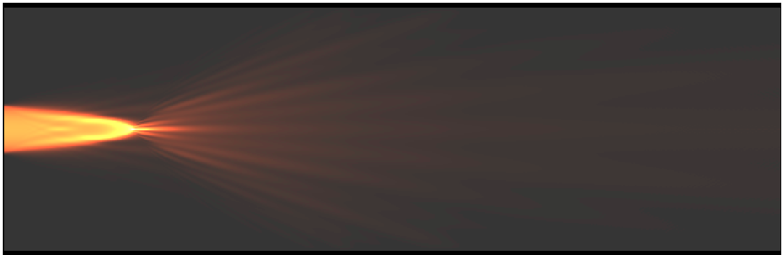
Рис. 4. Интенсивность светового пучка с гауссовым начальным распределением в средах с керровской нелинейностью при M = 10
